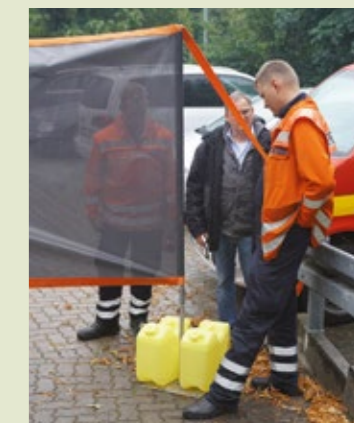
Die Halter für den freistehenden Aufbau des Gaffer-Stops können ganz einfach mit Schaummittelkanistern beschwert werden.
