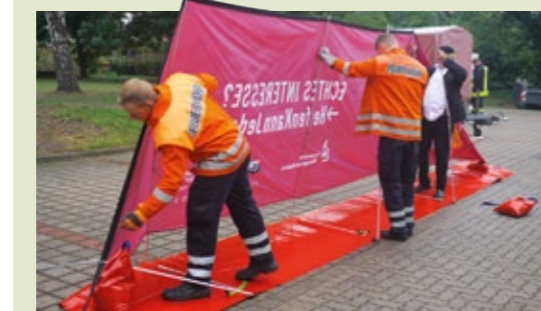
I-Shield ist die technisch anspruchsvollste Sichtschutzwand am Markt. Die Konstruktion ist auf einem eigenen Anhänger verstaute. Sie eignet sich vor allem für länger dauernde Einsätze, beispielsweise auf Autobahnen. Der Einzug des Sichtschutzes erfolgt per Motor. Die Rollen an den Pfosten (Pfeil) wurden bei unserem Test allerdings als zu klein bezeichnet.
