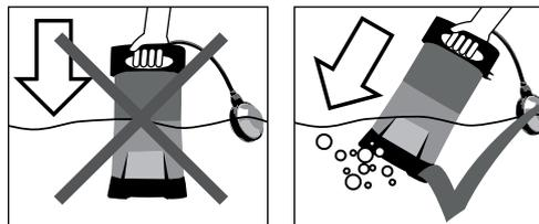
3. Se il dispositivo deve essere posato sul fondo, fare attenzione che ci sia un sottosuolo piano.
