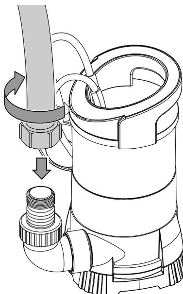
9. In alternativa, è possibile avvitare un tubo flessibile con filettatura interna (1 1/2") direttamente sull'adattatore a gomito (8).
