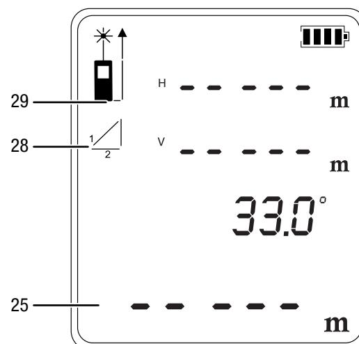
2. Rett apparatet mot det høyeste punktet (A) og trykk raskt på På-/Måle-knappen (7) én gang for å gjennomføre en måling. Hold da apparatet mest mulig i ro og sett det med begge de bakre kantene jevnt ned på underlaget. **Anslaget på de to bakre kantene må ikke forandres under målingen!**
