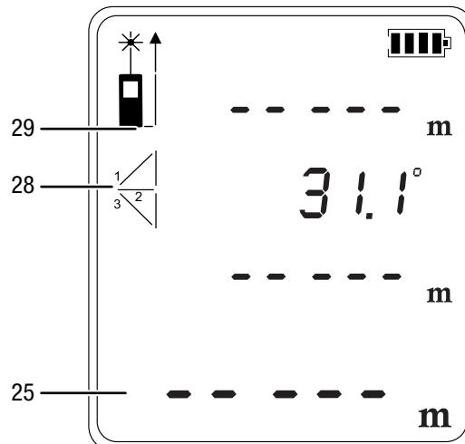
2. Rett apparatet først mot det høyeste punktet (C) og trykk raskt på På-/Måle-knappen (7) én gang for å gjennomføre en måling. Hold da apparatet mest mulig i ro.
