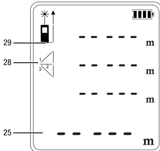
3. Rett apparatet først mot det høyeste punktet (C) og trykk raskt på På-/Måle-knappen (7) én gang for å gjennomføre en måling. Hold da apparatet mest mulig i ro.
