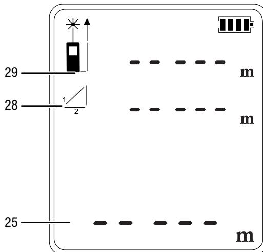
3. Rett apparatet først mot det høyeste punktet (A) og trykk raskt på På-/Måle-knappen (7) én gang for å gjennomføre en måling. Hold da apparatet mest mulig i ro og sett det med begge de bakre kantene jevnt ned på underlaget. **Anslaget på de to bakre kantene må ikke forandres under målingen!**
