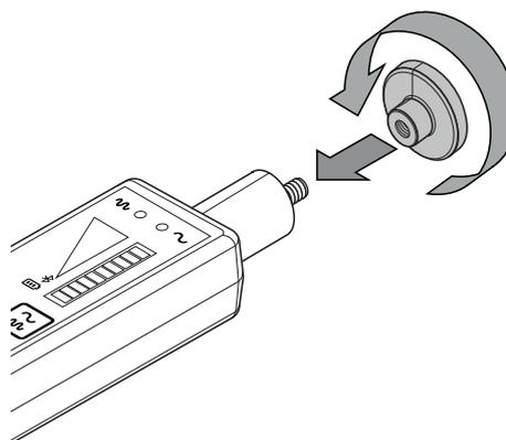
La seguente rappresentazione schematica fornisce un quadro generale delle possibili combinazioni. A seconda delle esigenze, è possibile utilizzare una o due prolunghe.
