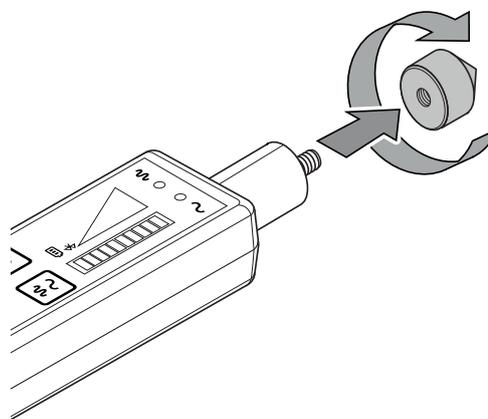
2. Avvitare ad es. l'adattatore magnetico sul dispositivo.
