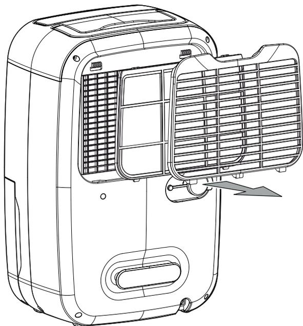
2. Pulire il filtro con un panno morbido, senza pelucchi e leggermente umido. Nel caso in cui il filtro dovesse essere molto sporco, lavarlo con acqua calda mischiata a un detergente neutro.
