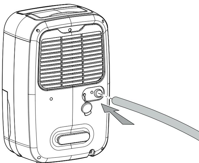
4. Portare l'estremità del tubo flessibile a uno scarico adatto (per es. un pozzetto di raccolta o un contenitore di raccolta sufficientemente grande). Fare attenzione, il tubo flessibile non deve essere piegato.
