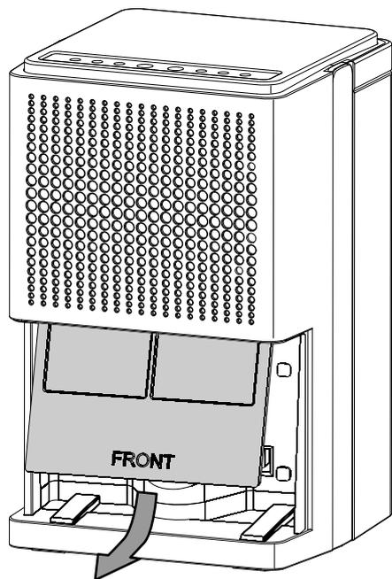
3. Pulire il filtro con un panno morbido, senza pelucchi e leggermente umido. Nel caso in cui il filtro dovesse essere molto sporco, lavarlo con acqua calda mischiata a un detergente neutro.
