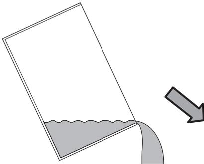
3. Sciacquare il contenitore di condensa con acqua pulita. Pulire il contenitore di condensa regolarmente con un detergente delicato (non utilizzare detersivi!).
