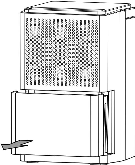
2. Svuotare il contenitore di condensa tramite uno scarico o un lavandino.
