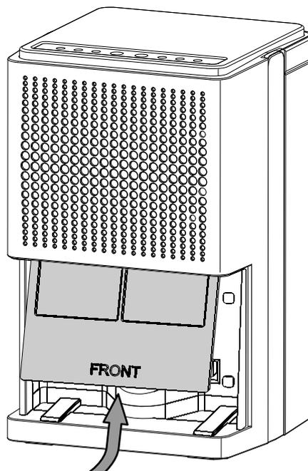
6. Inserire nuovamente il contenitore di condensa nel dispositivo.
