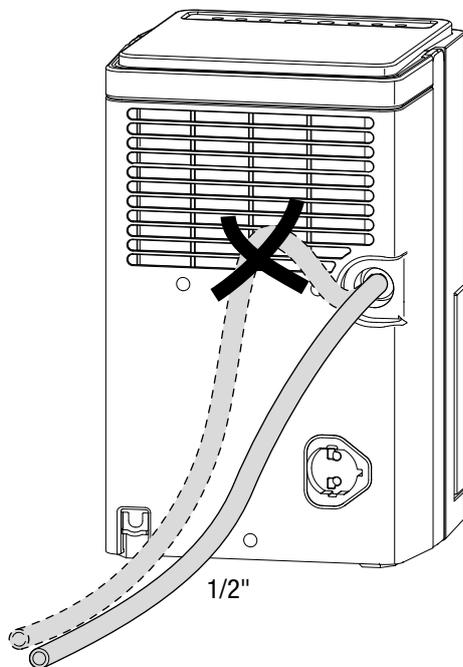
Rimuovere il tubo flessibile, se si desidera nuovamente raccogliere la condensa con il contenitore di condensa. Prima dello stoccaggio, far asciugare il tubo flessibile. Il tubo flessibile può essere allacciato per un utilizzo continuo in qualsiasi modalità di funzionamento.
