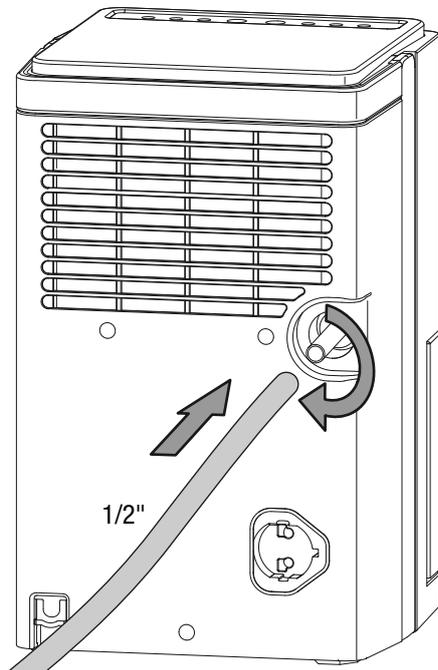
5. Portare l'estremità del tubo flessibile a uno scarico adatto (per es. un pozzetto di raccolta o un contenitore di raccolta sufficientemente grande). Fare attenzione, il tubo flessibile non deve essere piegato.
