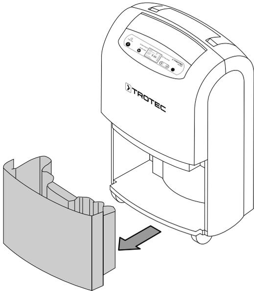
2. Svuotare il contenitore di condensa tramite uno scarico o un lavandino.
