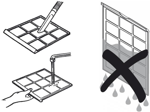
4. Far asciugare completamente il filtro. Non inserire un filtro bagnato nel dispositivo!
