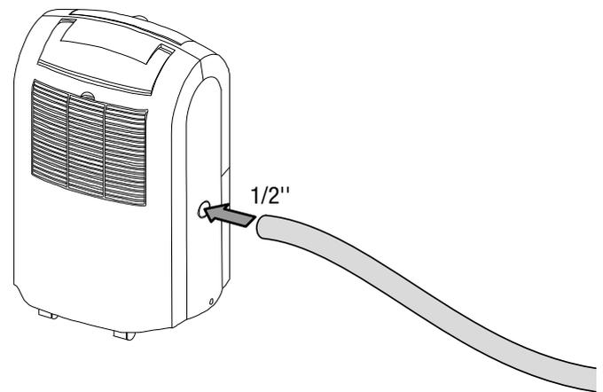
4. Controllare se il tubo flessibile è stato posizionato correttamente sull'allaccio. Se necessario, correggere la posizione attraverso l'apertura sul contenitore di condensa.
