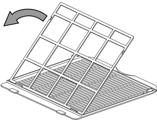
3. Pulire il filtro con un panno morbido, senza pelucchi e leggermente umido. Nel caso in cui il filtro dovesse essere molto sporco, lavarlo con acqua calda mischiata a un detergente neutro.
