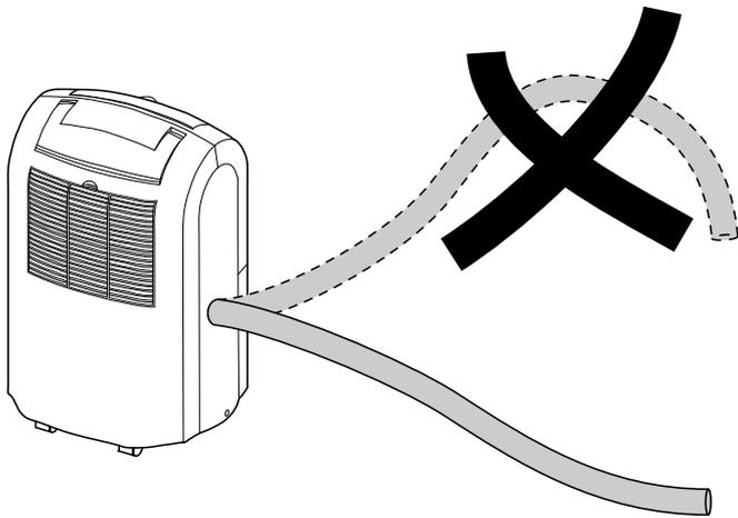
Rimuovere il tubo flessibile, se si desidera nuovamente raccogliere la condensa con il contenitore di condensa. Prima dello stoccaggio, far asciugare il tubo flessibile. Il tubo flessibile può essere allacciato per un utilizzo continuo in qualsiasi modalità di funzionamento.
