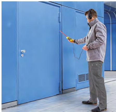
In combinazione con il trasmettitore a ultrasuoni SL800T è possibile eseguire in modo veloce ed economico il controllo della tenuta per esempio delle porte tagliafuoco.
