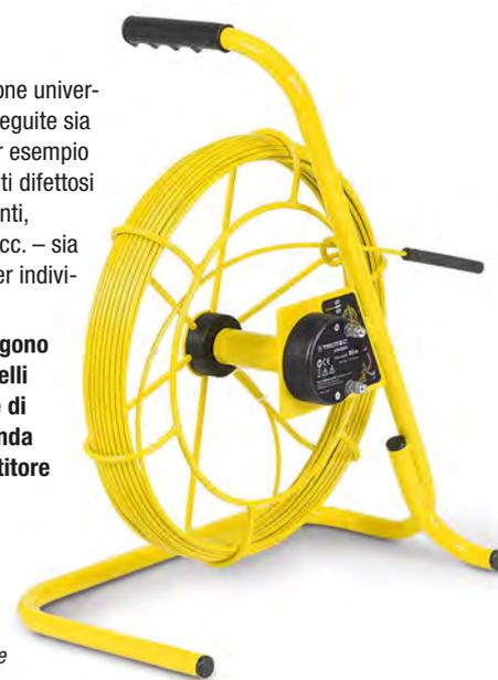
*Versione LTS: Struttura portatile compatta e adatta ai cantieri. Cavo in fibra di vetro rivestito di polipropilene con fili di rame integrati,  $\varnothing$  4,5 mm. Bobina di rilevamento del terminale, scatola di collegamento con spine e perni per due collegamenti di trasmettitori, struttura in tubi di acciaio con vernice protettiva con argano  $\varnothing$  400 mm.*
