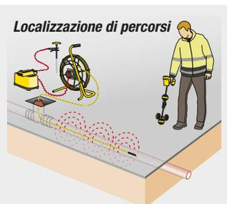
Sulla testa del cavo di spinta dei dispositivi LTS è stata applicata una sonda che è facilmente localizzabile grazie a un campo particolarmente forte. Il collegamento del trasmettitore viene fatto tramite due cavi alla scatola di collegamento del LTS.
