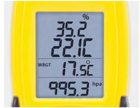
Il display LCD retroilluminato del TC100 indica contemporaneamente quattro grandezze, ben leggibili e visibili anche in ambienti scarsamente illuminati.
