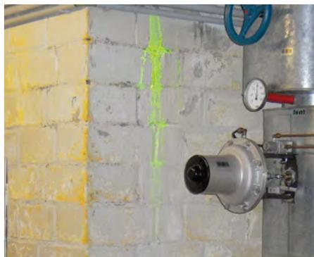
Localizzazione di una condotta dell'acqua non a tenuta nell'edificio, tramite introduzione di fluorescina e ispezione UV.
