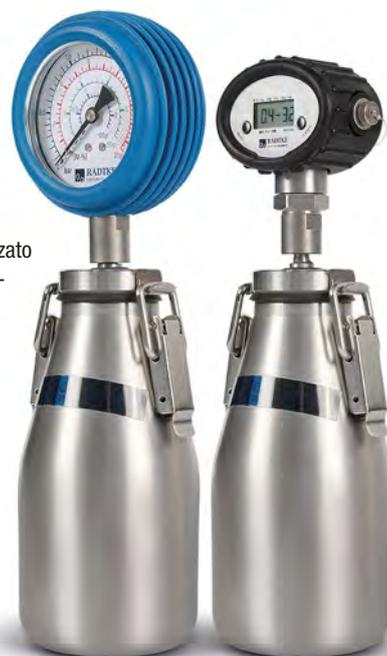
Se, ad esempio, è stata effettuata una misurazione a 35 °C costanti e si è letta una pressione di 0,8 bar, l'umidità CM% per una quantità pesata di 50 g è 1,57 CM% secondo la tabella o la scala.
