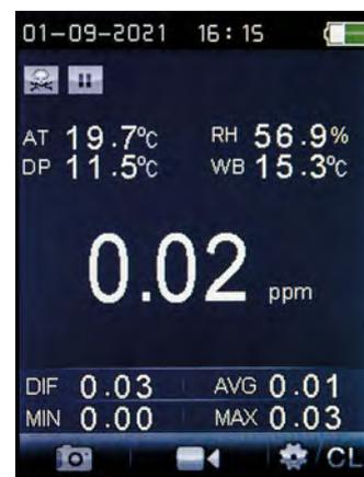
Tutti i contatori di particelle rilevano le frazioni delle dimensioni e la concentrazione delle particelle dell'aria su sei diversi canali, da 0,3 µm fino a 10 µm, con una rappresentazione aggiuntiva tramite indicatore a colore. Ottimale per il controllo delle contaminazioni, per esempio nei compartimenti stagni con un'atmosfera ad alta o a bassa pressione. Inoltre, sono possibili le misurazione dell'efficienza di filtri, con indicazione dell'efficienza in percentuale per frazioni di grandezza
