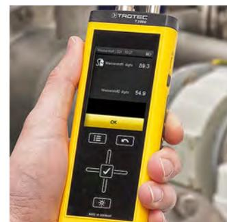
In questo modo l'utente può orientare la propria scelta sull'intervallo del segnale acustico o sul valore misurato indicato, per conoscere il più alto valore della concentrazione di H<sub>2</sub>, e così può circoscrivere in modo sistematico la perdita da localizzare.
