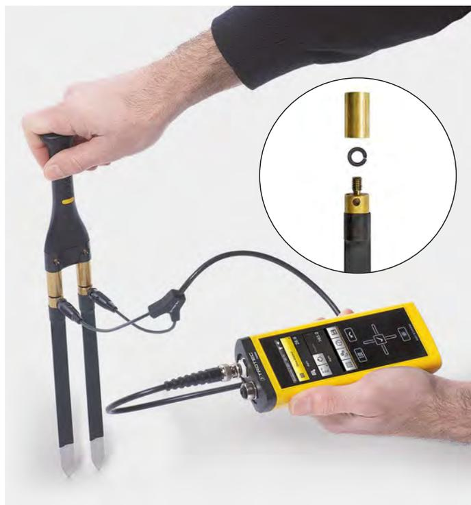
Con il set adattatori TS 60 (19) è possibile fissare tutti gli elettrodi MultiMeasure direttamente sull'elettrodo manuale TS 60 (9). Gli adattatori dispongono inoltre di una filettatura su entrambi i lati e vengono avvitati semplicemente con un anello tenditore tra la testa dell'elettrodo e la punta dell'alloggiamento dell'elettrodo manuale.
