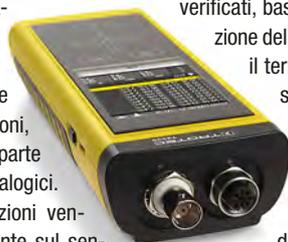
poter constatare delle correlazioni o perché durante la misurazione sono scaturiti nuovi aspetti che devono essere verificati, basta una semplice sostituzione del sensore – e in un attimo il termoigrometro diventa un sensore di umidità a microonde, il sensore di umidità dielettrico diventa un anemometro o il sensore temperatura diventa un sistema a idrogeno di localizzazione delle perdite.
