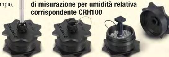
e la misurazione di ogni campione possono anche essere eseguiti in una sola volta, cioè prendendo il campione e riempiendo il CRH100 per poi iniziare il processo di misurazione, prendere il secondo campione nel frattempo e così via. Successivamente, i dati di misurazione possono essere inviati come file PDF o Excel.
