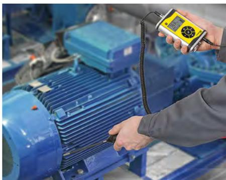
La sonda per le vibrazioni meccaniche con punta in acciaio inox è perfetta per eseguire controlli CND come gli esami dello stato di usura dei cuscinetti sui componenti delle macchine rotanti.
