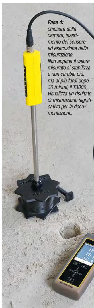
**Fase 4:** chiusura della camera, inserimento del sensore ed esecuzione della misurazione. Non appena il valore misurato si stabilizza e non cambia più, ma al più tardi dopo 30 minuti, il T3000 visualizza un risultato di misurazione significativo per la documentazione.
