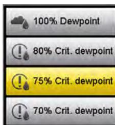
In particolare per l'analisi dei danni in ambienti con valori climatici ambientali altrimenti discreti, per le misurazioni per esempio dietro a cornici di quadri o dietro ad armadi a muro o armadi guardaroba è importante riconoscere il punto di rugiada critico.
