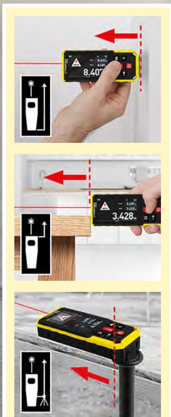
Per la misurazione con TD120 e TD200 è possibile scegliere tra diversi punti di riferimento: il bordo posteriore del misuratore, ad esempio quando lo si posiziona contro le pareti, il bordo anteriore, ad esempio quando si misura dal bordo di un tavolo.
