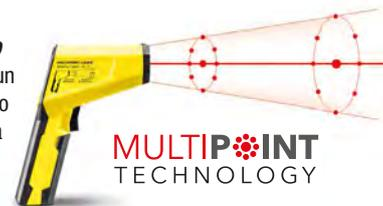
L'ausilio con puntatore laser multiplo del TP7 e del TP10 unisce entrambe le tecnologie per rilevare al contempo in modo semplice e preciso l'oggetto di misurazione: mentre un puntatore laser centrale mostra il punto di misurazione, altri otto laser visualizzano i punti sul perimetro della superficie di misurazione, aspetto che permette all'utente di eseguire misurazioni di precisione in brevissimo tempo.
