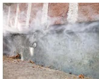
Prova di impermeabilizzazione difettosa dei giunti alle pareti sopra a un garage sotterraneo.
