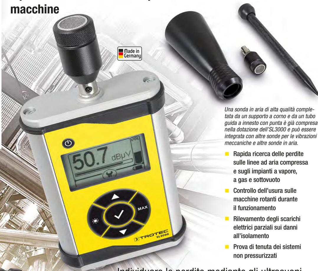
Una sonda in aria di alta qualità completata da un supporto a corno e da un tubo guida a innesto con punta è già compresa nella dotazione dell'SL3000 e può essere integrata con altre sonde per le vibrazioni meccaniche e altre sonde in aria.
