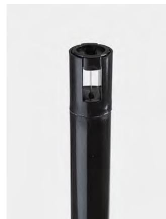
Grazie a questi sensori è possibile misurare contemporaneamente la velocità del flusso d'aria e la sua temperatura e visualizzare i dati sul display del T3000.
