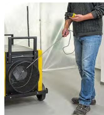
La sonda telescopica sottile del TA300 può essere estratta in modo variabile fino a un 1 m di lunghezza utile e consente un intervento di misurazione comoda. Pratico anche per le misurazioni del flusso su punti distanti e difficilmente raggiungibili o in canali d'aria interni e in pozzi.
