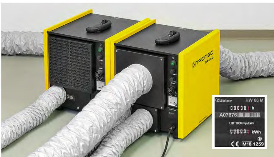
A sinistra un TTR 400 con coperchio del filtro standard sul retro e tubo flessibile collegato per lo scarico dell'aria umida. A destra un TTR 400 D con adattatori per tubi flessibili forniti come optional per un'adduzione separata in ogni ambiente di aria di processo e di rigenerazione.
