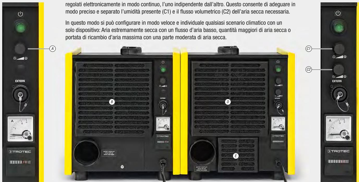
Le differenze dei modelli a confronto diretto: Sul lato sinistro un TTR 400 con regolazione della portata dell'aria Monoventic (A) e ingresso combinato per entrambi i flussi dell'aria (B), a destra un TTR 400 D con regolazione Duoventic (C1, C2) e ingressi separati per l'aria secca (D) e l'aria di rigenerazione (E).
