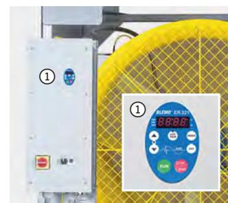
Il telaio del TTW 100000 ospita una staffa del convertitore di frequenza con pannello di controllo sul retro ①. Il supporto, che può essere fissato per il trasporto, può essere svitato in modo variabile durante il funzionamento per agevolare l'accesso operativo.
