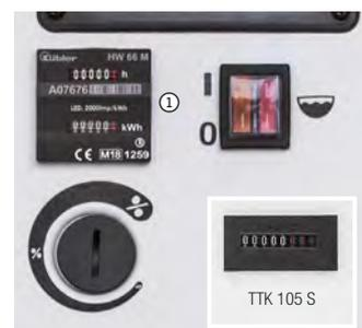
L'interruttore di servizio e la spia luminosa che segnala il raggiungimento del livello massimo di riempimento (TTK 105/650 S escluso) sono protetti contro la polvere e dagli spruzzi d'acqua grazie a uno sportellino di protezione, e un interruttore rotante dell'igrostat, provvisto di fessure, garantisce che la posizione dell'interruttore non venga spostata inavvertitamente.
