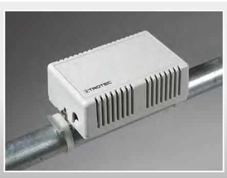
In questo modo il misuratore controlla la formazione della condensa e in caso di superamento del valore soglia, selezionabile individualmente attraverso il microinterruttore situato all'interno, comanda automaticamente un deumidificatore collegato tramite morsetti. Il controllore del punto di rugiada non necessita di alcuna tensione di alimentazione ed è utilizzabile in modo flessibile per tubi con diametro max. di 50 mm.
