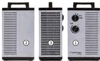
Una doppia entrata dell'aria sul lato anteriore (1) e posteriore (2) del riscaldatore alimenta il potente ventilatore radiale con un grande volume di aria di aspirazione, che poi viene soffiata nell'ambiente come flusso d'aria calda su tutta la superficie, tramite la griglia di emissione dell'aria laterale (3).
