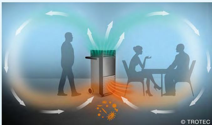
In un processo continuo, l'aria della stanza contaminata da particelle di aerosol e virus infettivi viene diluita e spinta in basso verso il pavimento da una sorta di "effetto rullo d'aria".
