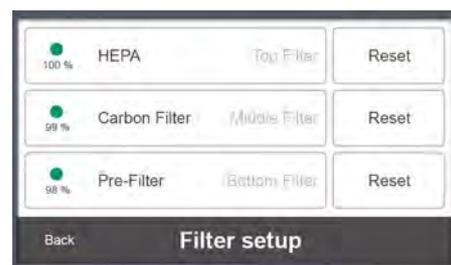
Il depuratore d'aria informa sullo stato di consumo dei filtri dell'aria installati e segnala la necessità di sostituire i filtri.
