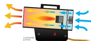
*I riscaldatori diretti a gas della Serie TGH-E aspirano l'aria dell'ambiente circostante tramite turboventilatore, riscaldano quindi il flusso di aria principale direttamente tramite il bruciatore a gas per rilasciare poi aria calda.*
