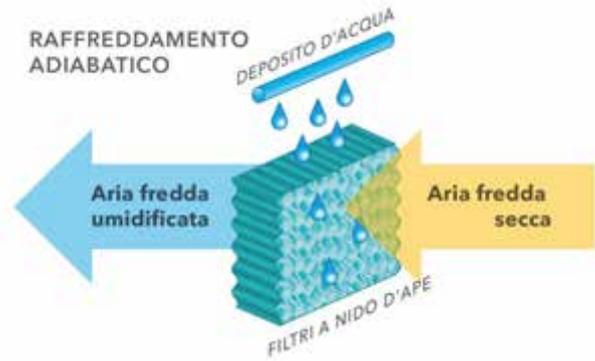
Il principio fisico del raffreddamento adiabatico con gli Aircooler mobili
