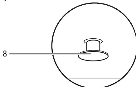
Uređaj se može rabiti tek kada se sklopka za zaštitu od prevrtanja (8) potpuno gurne u uređaj. To se događa automatski kada uređaj postavite na prikladnu podlogu.
